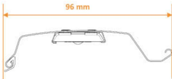
Vue en coupe de la lame et du support de lame
